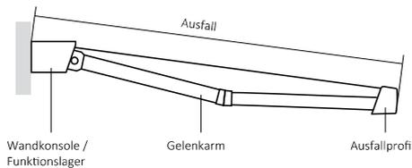
Aluminium; stranggepresst; C-förmig; pulverbeschichtet; seitliche Endkappen aus Aluminium-Druckguss
