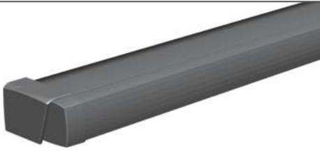
2 mm starkes Aluminium; stranggepresst; Oberfläche pulverbeschichtet; zweiteilig; obere Abdeckung abnehmbar; Abmessung bis Breite 500 cm Tiefe 240 mm über 500 cm Breite 245 mm; Tiefe 130 mm; Kabelauslass Hinten Unten am Bodenprofil; Seitenteile Aluminium-Druckguss; Dichtprofil aus Silikon; optional; LED-Beleuchtung zur bauseitigen Verkabelung in Nut über die Länge der Kassette geführt
