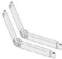
Aluminium; stranggepresst; pulverbeschichtet; Gelenke aus Aluminium-Druckguss; Kraftübertragung mit innenliegenden Federn und Stahllitzen verstärktem Gelenkband; Armlager mit Kippgelenk und integrierter Hochschlagsicherung
