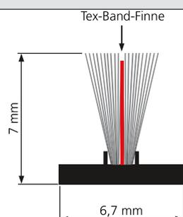
Die Soft-Fin Bürsteneinlage mit Tex-Band Finne sorgt für einen sanften und ruhigen Lauf des Rollladenbehangs. Sie wird bei den Führungsschienen der Mini-Rollläden sowie der Softführungsschienen bei der Rollladen Komplettierung verwendet. Sie bietet gegenüber Neopren-Einlagen den Vorteil, dass sie weicher und geschmeidiger bleibt.
