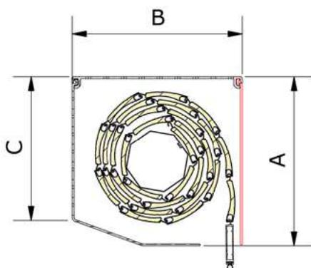
Aluminium; 2 mm; stranggepresst; Revisionsblende eckig mit 20° Schräge; Revision von vorne; zur Raumseite hinten offen; Seitenteile aus Aluminium-Druckguss; Stahlachtkantwelle mit Gleitlager; optional Kastenblende geschlossen KBG (Aufpreis)
