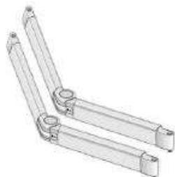
Aluminium; stranggepresst; pulverbeschichtet; Kraftübertragung mit innenliegenden Doppelfederzügen; Federspannung mittels spezieller rostfreier Edelstahl Flyerkette
