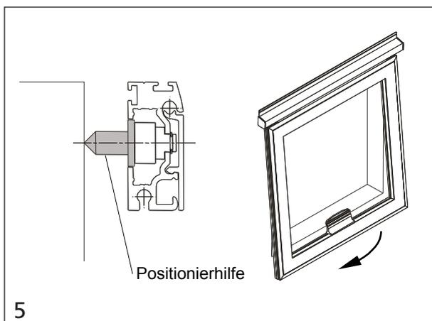
Positionierhilfen 06.563 auf die im Rahmen eingelassenen Magnete aufsetzen und mit leichtem Druck auf den Rahmen Markierungen am Fensterrahmen erzeugen.
