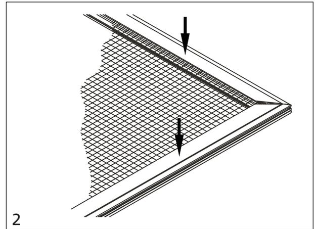
Die Blenden 06.824.xxx mittels festem Druck einclippen.
