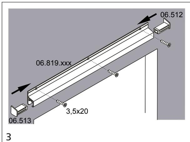
Vormontierten Rahmen mit Einhängeprofil 06.819.xxx an die Fensterrahmen-Außenfläche halten, nach dem Fenster ausrichten und Position des Einhängeprofils am Fenster anzeichnen.
