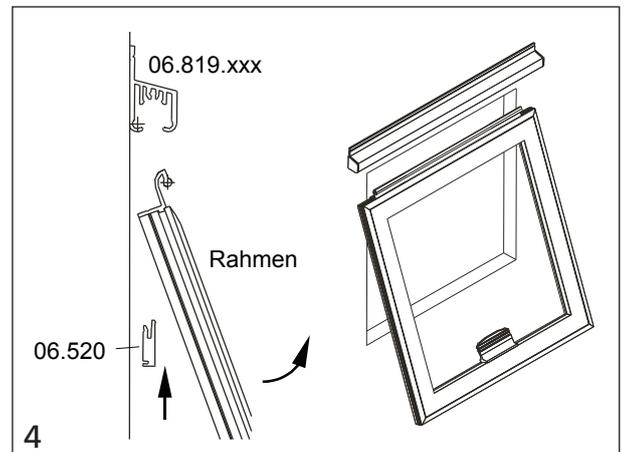
Vormontierten Rahmen in das Einhängeprofil 06.819.xxx einhängen. Überprüfen Sie nun die Position und Klappfunktion des Rahmens.
