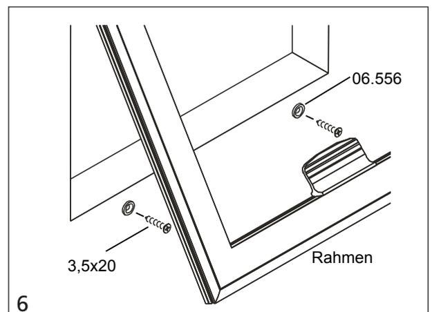
An den markierten Stellen die Magnetplatte 06.556 mit Holzschrauben 3,5 x 20 anschrauben. Bei starkem Wind ist der Rahmen gegen unbeabsichtigtes Öffnen zu sichern. Zur Demontage die Kunststoffsicherungen mit einem Schraubendreher aushebeln.
